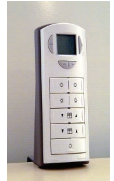
Bediengerät von Landis & Staefa, integriert in eine offene LON-Umgebung
